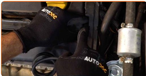
**5** Destornille la atadura de la bobina del encendido. Utilice Torx T40. Utilice una llave de trinquete.
