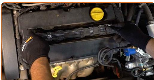
**15** Apriete la atadura de la bobina del encendido. Utilice Torx T40. Utilice una llave de trinquete.
