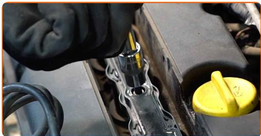
**16** Trate el conector de la bobina de encendido con spray para electrónica. El spray protegerá los contactos eléctricos de la corrosión, oxidación, y reducirá la resistencia de contacto.
