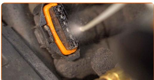
**17** Enchufe el conector de la bobina de encendido.
