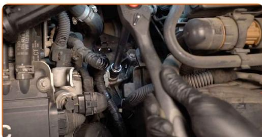
**22** Inserte el embudo. Vierta nuevo líquido de transmisión en la caja de cambios a través del orificio del respiradero. Cantidad requerida de aceite: 1.6 l.
