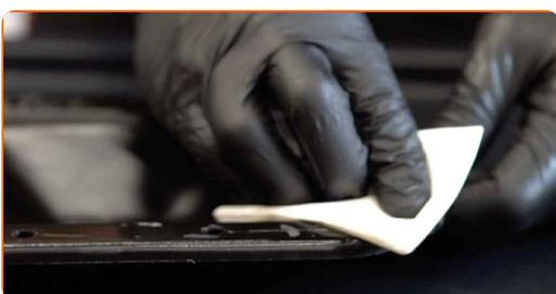
**15** Aplique sellador al asiento de montaje de la junta de la bandeja del líquido de transmisión. Proceda a instalar la nueva junta de la bandeja del líquido de transmisión.
