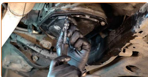
**19** Retire las sujeciones y mueva hacia un lado el tubo de líquido refrigerante.
