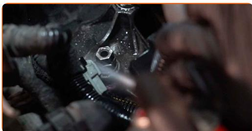
**21** Desatornille el respiradero de la caja de cambios. Use un vaso de impacto del n.º 16. Utilice una llave de trinquete.
