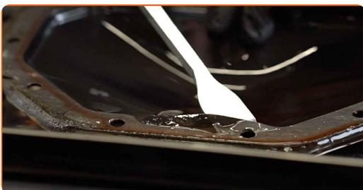
**14** Limpie el asiento de montaje de la junta de la bandeja del líquido de transmisión. Use un cepillo de alambre. Utilice el limpiador y diluyente.
