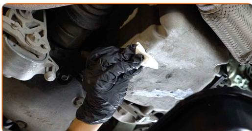
**16** Atornille en el nuevo tapón de drenaje y apriételo. Utilice Torx T40. Utilice una llave dinamométrica. Apriételo a un par de 24 Nm.
