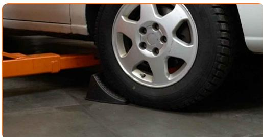
**3** Afloje los pernos de fijación de la rueda. Utilice una llave de impacto para llanta # 19.
