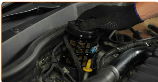
**8** Coloque la cubierta del filtro de combustible ensamblada con un viejo cartucho de filtro en un recipiente.
