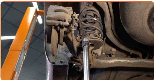
**9** Destornille la fijación inferior del amortizador. Use un vaso de impacto del n.º E20. Utilice una llave de trinquete.
