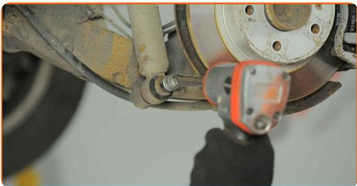
**8** Sostenga el eje de torsión de la suspensión trasera. Utilice un gato de transmisión hidráulica.
