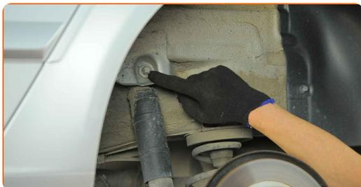
**7** Afloje la sujeción inferior del amortiguador. Use un vaso de impacto del n.º E20. Utilice una llave de trinquete.
