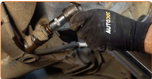
**10** Retire el perno de sujeción.
