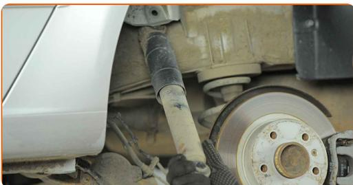
**14** Limpie los asientos de montaje del amortiguador. Use un cepillo de alambre. Use el aerosol WD-40.
