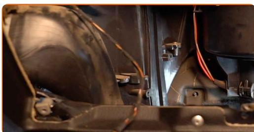
**12** Conecte las sujeciones que conectan el tubo de aire y el arnés del cableado a la carcasa del filtro de aire.
