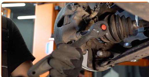
**13** Separe las pastillas de freno. Use una palanca.
