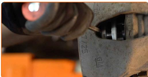
**14** Tire a un lado del muelle de retención de la pinza de freno. Use una palanca.
