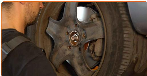
Sustitución: pinza de freno - VAUXHALL Astra Mk V (H) TwinTop (A04).
