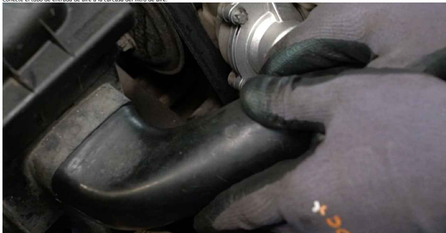
32 Coloque el clip en la manguera de admisión del filtro de aire.
