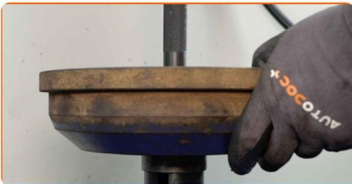
**17** Limpie el asiento de montaje del cojinete del cubo (buje). Utilice un spray de limpieza multiuso.
