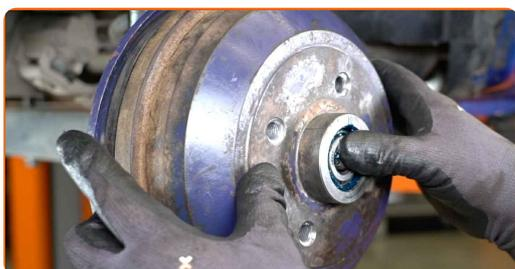
**25** Ajuste la arandela del rodamiento de la rueda.
