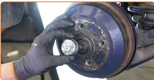
**7** Retire el pasador de chaveta que fija la tuerca del cubo. Use una palanca. Utilice un destornillador plano.
