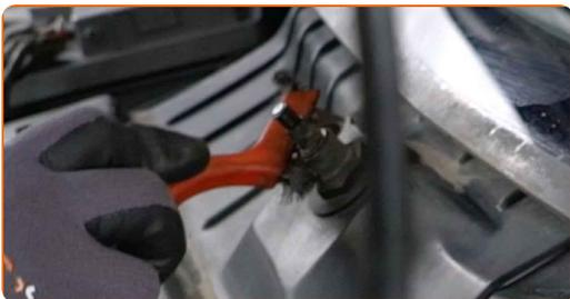
**12** Desenrosque las sujeciones del panel de plástico. Usa una llave mixta del n.º 24.
