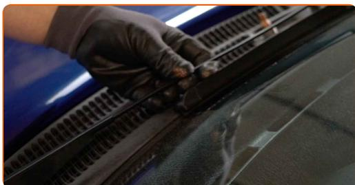
**30** Apriete las sujeciones del brazo del limpiaparabrisas. Use un vaso de impacto del n.º 13. Utilice una llave dinamométrica. Apriételo a un par de 14 Nm.
