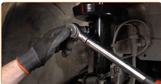
**58** Trate las sujeciones del amortiguador. Use grasa de cobre.
