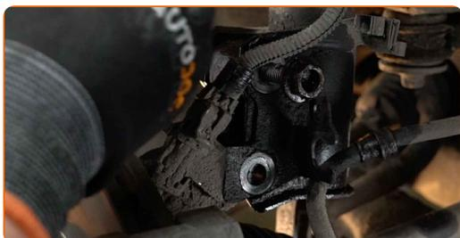
**26** Desconecte el muñón de dirección de la pata amortiguadora.
