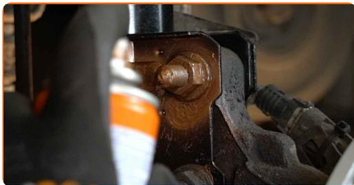
**59** Trate la superficie donde el disco del freno entra en contacto con la llanta de la rueda. Use grasa de cobre.
