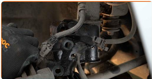
**27** Destornille la fijación superior de la cazoleta de la pata amortiguadora.
