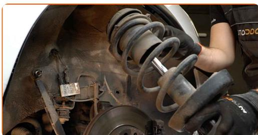
**29** Instale la pata amortiguadora en el mecanismo para apretar los resortes.
