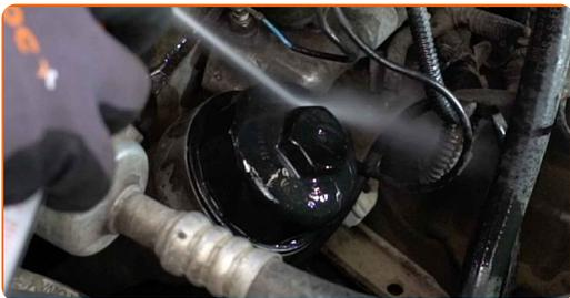
**6** Destornille la tapa del cuerpo del filtro junto con el elemento filtrante antiguo. Use un vaso de impacto del n.º 32. Utilice una llave de trinquete.
