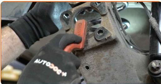
**26** Separe el cojinete del cubo de la placa de protección del disco de freno. Utilice un martillo.
