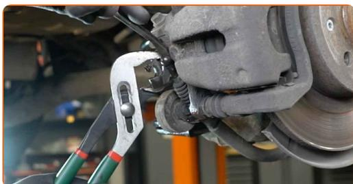
**8** Destornille la fijación del cáliper de freno. Use una llave mixta del n.º 13. Use una llave mixta del n.º 17.
