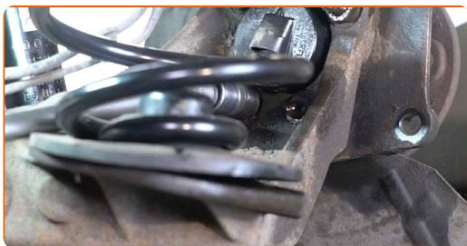
**22** Desenrosque las sujeciones del soporte del arnés de cables del ABS. Use un vaso de impacto del n.º E8. Utilice una llave de trinquete.
