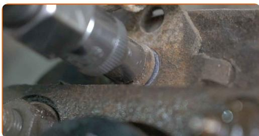
**23** Retire el soporte del arnés de cables del ABS.
