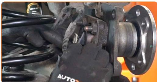
**34** Instale el soporte del arnés de cables del ABS.
