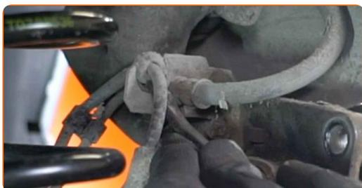
**19** Suelte el conector del sensor ABS. Use una palanca.
