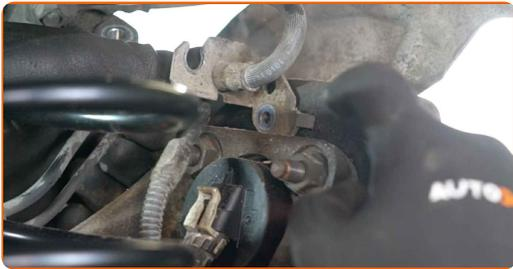
**35** Apriete la sujeción del soporte del arnés de cables del ABS. Use un vaso de impacto del n.º E8. Utilice una llave dinamométrica. Apriételo a un par de 7 Nm.
