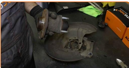
**27** Trate los sujetadores del cojinete del cubo de la rueda. Use grasa de cobre.
