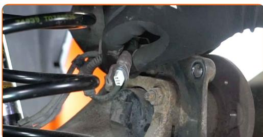
**20** Limpie las sujeciones del rodamiento del cubo de rueda. Use un cepillo de alambre. Use el aerosol WD-40.
