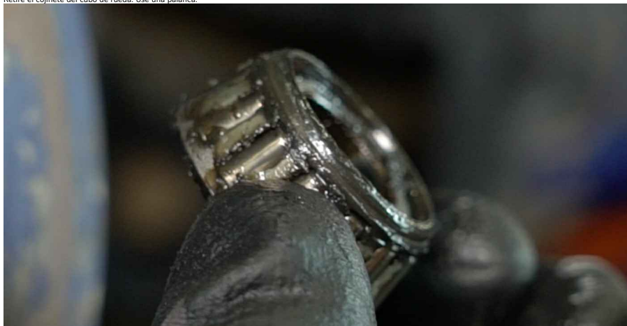
11 Quite el tambor de freno ensamblado junto con el cojinete del cubo de rueda.
