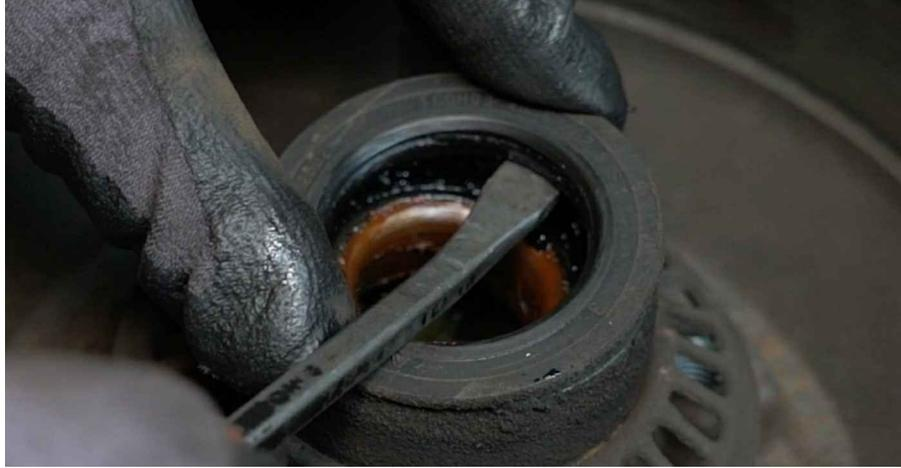
13 Retire el cojinete del cubo de rueda. Use una palanca.
