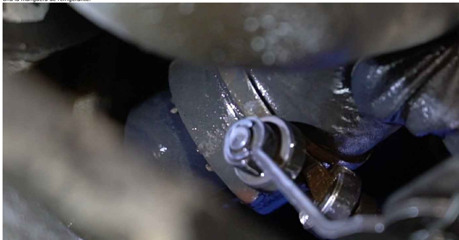
11 Asegure la abrazadera de la manguera de refrigerante. Utilice alicates para abrazaderas clic-R.
