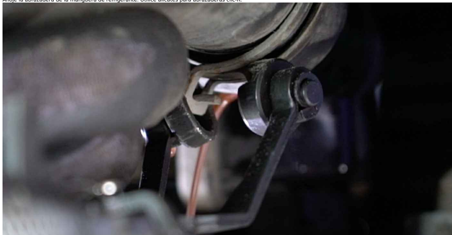
8 Separe la manguera de refrigerante.
