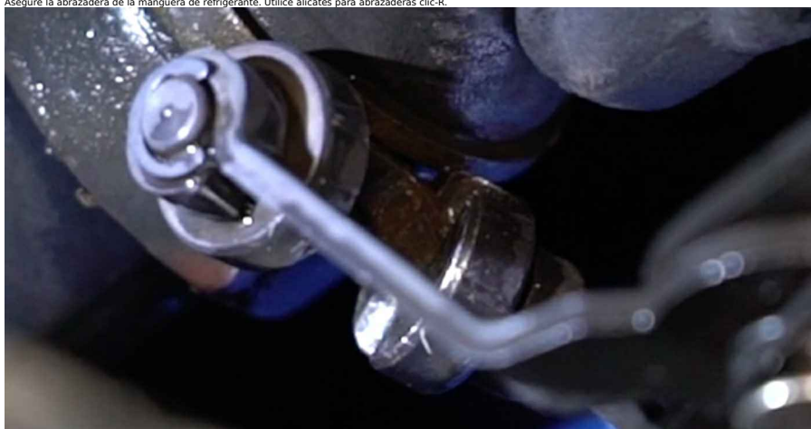
11 Asegure la abrazadera de la manguera de refrigerante. Utilice alicates para abrazaderas clic-R.
