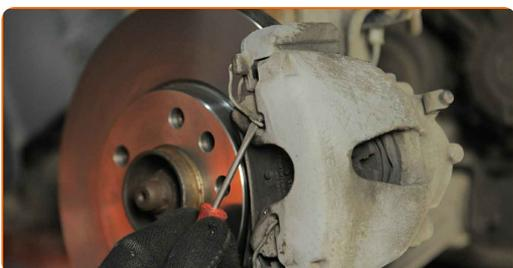
**8** Quite los tapones de los guardapolvos de las guías del cáliper. Utilice un destornillador plano.
