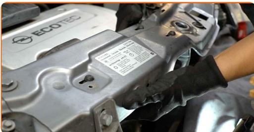
**35** Atornille las sujeciones de la carcasa del ensamblado de distribución de aire. Utilice Torx T20.
