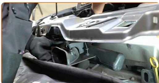
**5** Destornille la sujeción de la cubierta del motor. Utilice Torx T30. Utilice una llave de trinquete.
