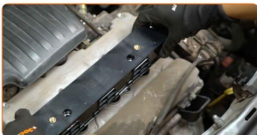
**24** Apriete los pernos de la bobina de encendido. Utilice Torx T30. Utilice una llave dinamométrica. Apriételo a un par de 7 Nm.
