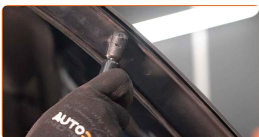
**9** Haga encajar la arandela de ajuste que conecta el amortiguador de gas a la carrocería del automóvil.
