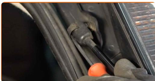
Sustitución: amortiguador de maletero - VAUXHALL Corsa Mk II (C) Hatchback (X01). Los expertos de AUTODOC recomiendan:
