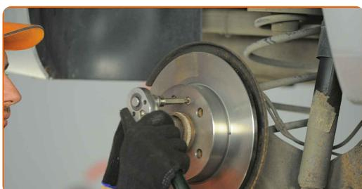
**17** Limpie los asientos de montaje de la pinza de freno y su soporte. Use un cepillo de alambre. Use el aerosol WD-40.
