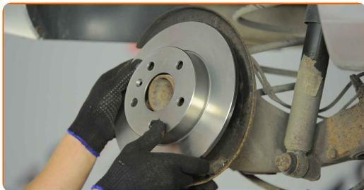
**16** Apriete la fijación del disco de freno. Utilice Torx T30. Utilice una llave dinamométrica. Apriételo a un par de 4 Nm.
