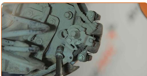
**21** Trate la superficie donde el disco del freno entra en contacto con la llanta de la rueda. Use grasa de cobre.
