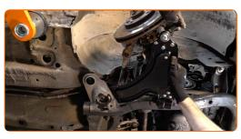
Sustitución: brazo inferior de la parte delantera - VAUXHALL Corsa Mk II (C) Hatchback (X01). Consejo de AUTODOC:
