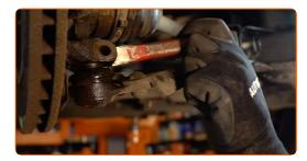
17 Retire el perno de sujeción.
