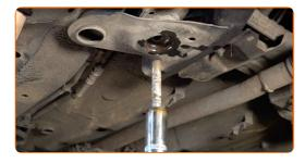
Desconecte el soporte esférico del muñón de dirección. Utilice un cincel de metal plano. Utilice un martillo.
