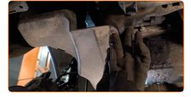
Retire la cubierta del paso de rueda.
