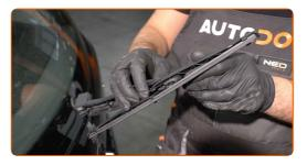
Sustitución: escobillas limpiaparabrisas - VAUXHALL Corsa Mk III (D) Hatchback (S07). Consejo de AUTODOC:
