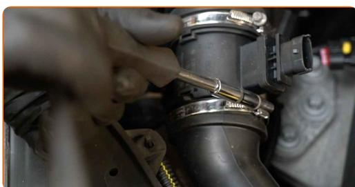
**5** Afloje los tornillos de sujeción de la cubierta del filtro de aire. Utilice Torx T20. Utilice una llave de trinquete.
