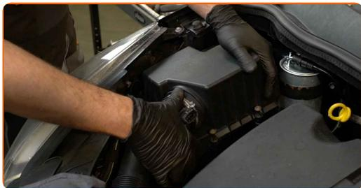
**15** Atornille los tornillos de sujeción de la cubierta del filtro de aire. Utilice Torx T20. Utilice una llave de trinquete.
