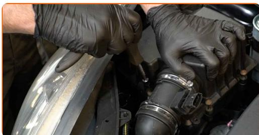
**16** Fije la abrazadera en el manguito de admisión de aire. Use un vaso de impacto del n.º 7. Utilice una llave de trinquete.
