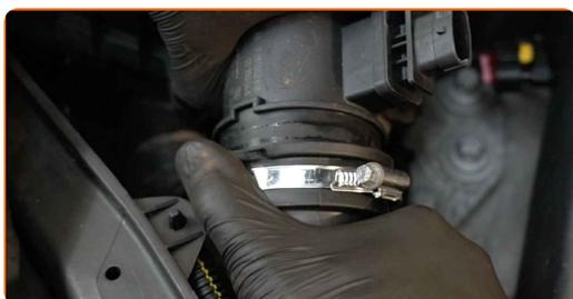
**Sustitución: filtros de aire - VAUXHALL Corsa Mk IV (E) Hatchback (X15).
