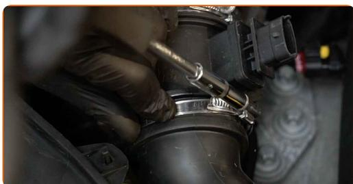
**17** Enchufe el conector del sensor de flujo de aire.
