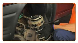
Atornillen la fijación superior de la cazoleta de la pata amortiguadora.
