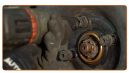
Baje el automóvil y, manteniendo el orden cruzado, apriete los pernos de fijación de las ruedas. Utilice una llave de impacto para llanta # 17. Utilice una llave dinamométrica. Apriételo a un par de 110 Nm.
