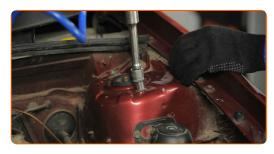
Sustitución: copelas del amortiguador - VAUXHALL CORSAVAN Mk I (B). Consejo de los expertos de AUTODOC:
