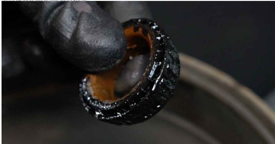
14 Limpie el asiento de montaje del cojinete del cubo (buj).
