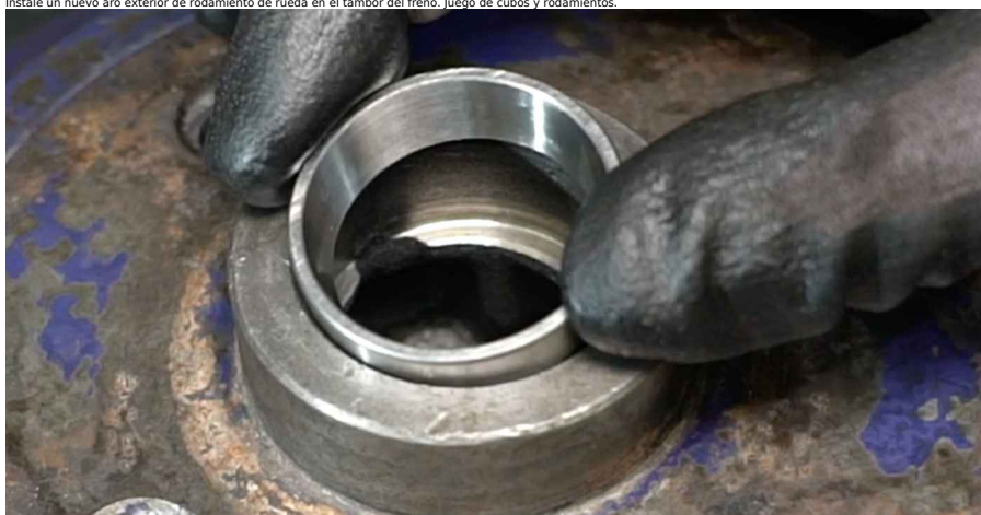
19 Instale la nueva pista interior del cojinete de rueda en el tambor de freno. Juego de cubos y rodamientos.
