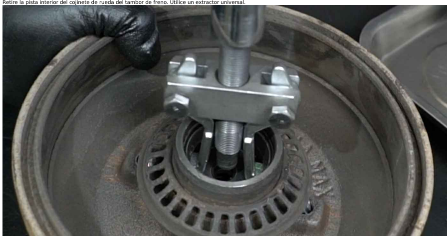
16 Retire el aro exterior del rodamiento de rueda del tambor del freno. Utilice un juego de cubos y rodamientos.
