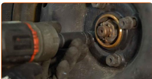
**23** Baje el automóvil y, manteniendo el orden cruzado, apriete los pernos de fijación de las ruedas. Utilice una llave dinamométrica. Apriételo a un par de 110 Nm.
