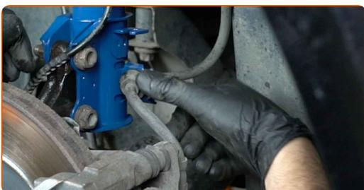
**55** Instale el clip de retención del latiguillo de freno. Utilice un mazo de goma.
