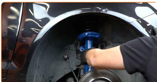
**48** Atornillen la fijación superior de la cazoleta de la pata amortiguadora. No lo apriete.
