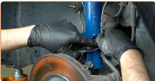
**57** Instale la barra del estabilizador de estabilidad transversal.
