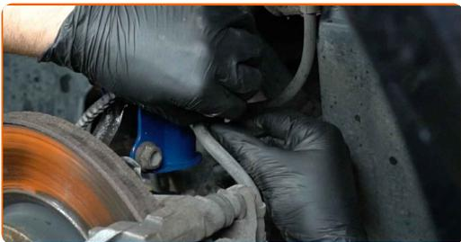
**56** Conecte los cables del captador ABS.
