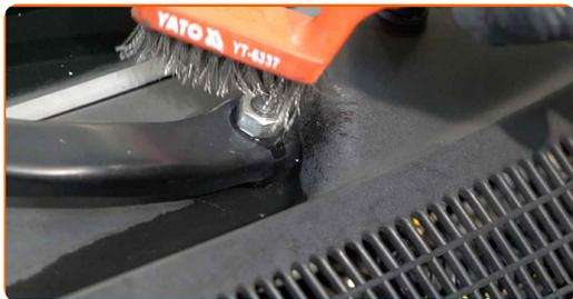
**6** Desenrosque las fijaciones de los brazos del limpiaparabrisas. Use un vaso de impacto del n.º 13. Utilice una llave de trinquete.
