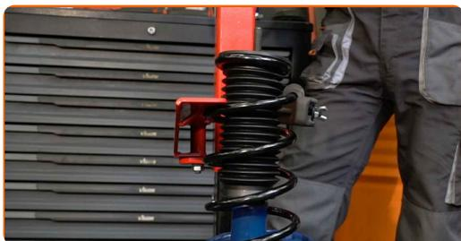
**42** Instale el soporte de montaje superior del puntal y el cojinete del soporte de montaje del puntal.
