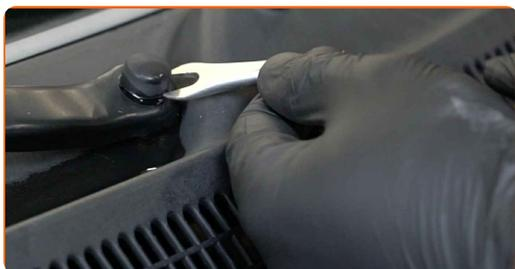
**5** Trate las sujeciones del brazo del limpiaparabrisas. Use un cepillo de alambre. Use el aerosol WD-40.
