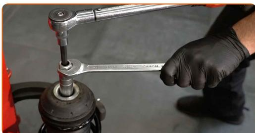
Sustitución: amortiguador telescópico - VAUXHALL Corsavan Mk III (D) (S07).
