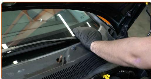
**71** Apriete las fijaciones de los brazos del limpiaparabrisas. Use un vaso de impacto del n.º 13. Utilice una llave dinamométrica. Apriételo a un par de 21 Nm.
