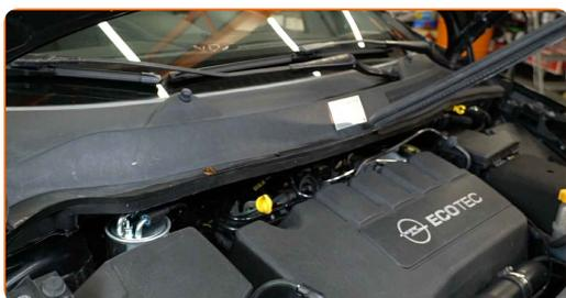
**4** Retire las cubiertas de las tuercas del brazo del limpiaparabrisas. Utilice una herramienta de extracción de clips.
