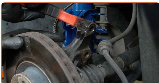
**50** Fije la pata amortiguadora en el muñón de dirección.
