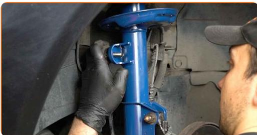
**58** Apriete la sujeción que conecta la bieleta de barra estabilizadora al amortiguador. Usa una llave mixta del n.º 15. Utilice Torx T30. Utilice una llave dinamométrica. Apriételo a un par de 40 Nm.
