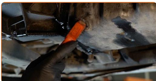
**7** Destornille el tapón de desagüe. Utilice Torx T45. Utilice una llave de trinquete.
