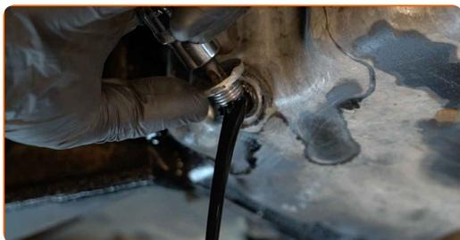
Sustitución: aceite de motor y filtro - VAUXHALL Frontera Mk II (B) SUV (U99).
