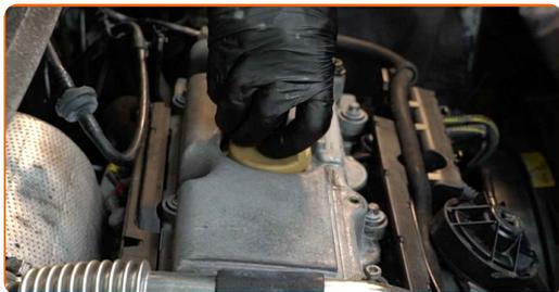
**29** Pongan en marcha el motor por unos minutos. Después de que se apague la luz de advertencia de presión del aceite, detenga el motor.
