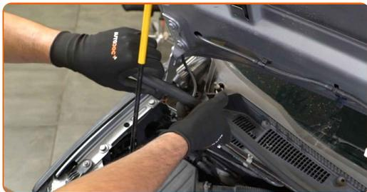
**9** Desatornille las sujeciones de la bandeja del limpiaparabrisas. Use un vaso de impacto del n.º 8. Utilice una llave de trinquete.
