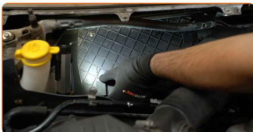
**23** Conecte los clips de la cubierta del filtro del habitáculo.
