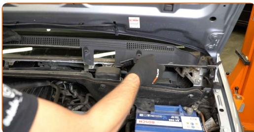
**12** Desatornille las sujeciones de la bandeja del limpiaparabrisas. Use un vaso de impacto del n.º 8. Utilice una llave de trinquete.
