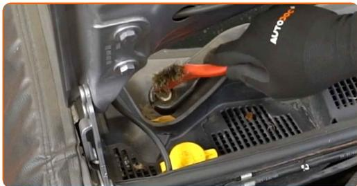
**5** Desenrosque las fijaciones de los brazos del limpiaparabrisas. Use un vaso de impacto del n.º 13. Utilice una llave de trinquete.
