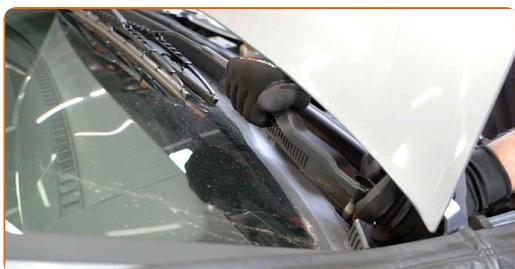
**7** Desenrosque las sujeciones de la rejilla del limpiaparabrisas. Use un vaso de impacto del n.º 8. Utilice una llave de trinquete.
