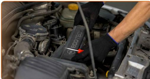
**5** Desconecte el conector de la bobina de ignición. Utilice un destornillador plano.
