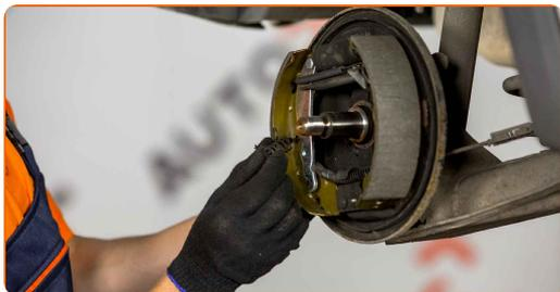
**20** Inserte los muelles de parada en las enclavaduras en los pasadores. Use alicates de punta redondeada. Utilice un destornillador plano.
