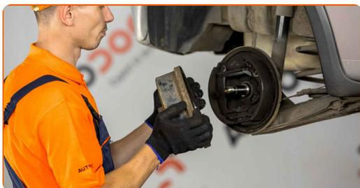
**12** Desconecte el cable del freno de mano del brazo de la zapata de freno. Use alicates de punta redondeada. Utilice un destornillador plano.
