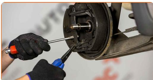
**13** Saque los muelles de parada de pastillas de freno de sus orificios. Utilice alicates.
