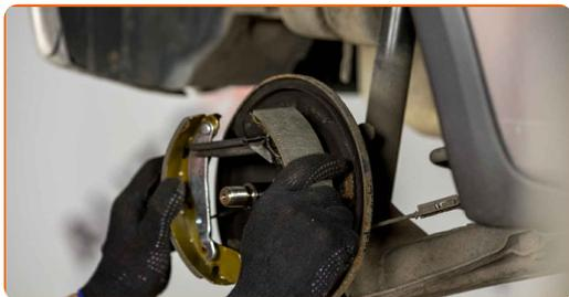
**19** Instale los clips de retención de las pastillas de freno. Use alicates de punta redondeada.
