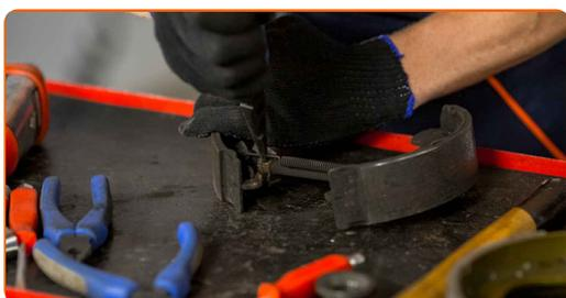
**17** Inserte el mecanismo de ajuste de las pastillas de freno. Use alicates de punta redondeada.
