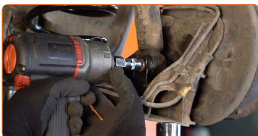
**14** Retire el perno de sujeción.
