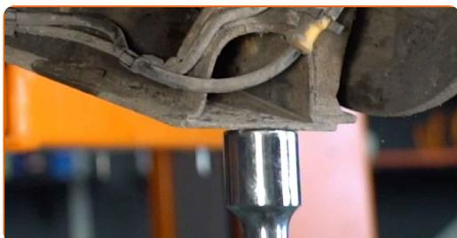
**23** Atornille la sujeción inferior del amortiguador. Use un vaso de impacto del n.º E14.
