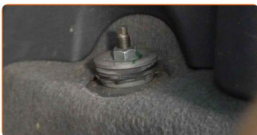
**4** Limpie las fijaciones del soporte de montaje superior del amortiguador. Use el aerosol WD-40.
