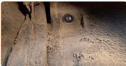
**19** Coloque el amortiguador en el arco de la rueda y fíjelo.
