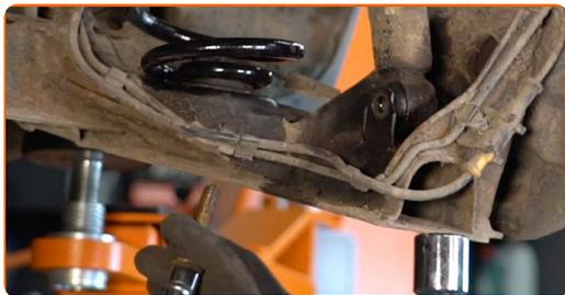
**15** Retire el soporte por debajo de la viga trasera.
