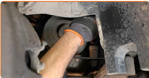
**10** Vuelva a colocar la polea tensora en su posición inicial. Usa una llave mixta del n.º 19.
