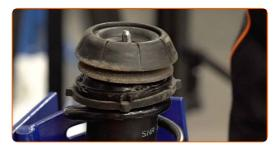
Apriete la tuerca de la varilla de la pata amortiguadora. Usa una llave mixta del n.º 19. Use un vaso de impacto del n.º 9. Utilice una llave dinamométrica. Apriételo a un par de 50 Nm.
