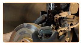
En la pata fije el latiguillo del sistema de freno.
