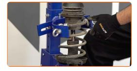
Destornille la tuerca de la varilla de la pata amortiguadora. Usa una llave mixta del n.º 19. Use un vaso de impacto del n.º 9.
