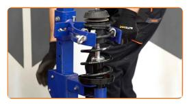
Retire el puntal amortiguador que está montado.
