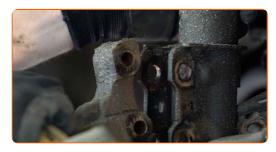
Destornille la fijación superior de la pata amortiguadora. Usa una llave mixta del n.º 19. Use un vaso de impacto del n.º 9. Utilice una llave de trinquete.
