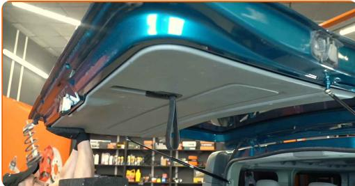
**3** Desenrosque el elemento de sujeción de la tercera luz de freno. Utilice una llave de vaso de 8 mm. Utilice una llave de carraca.
