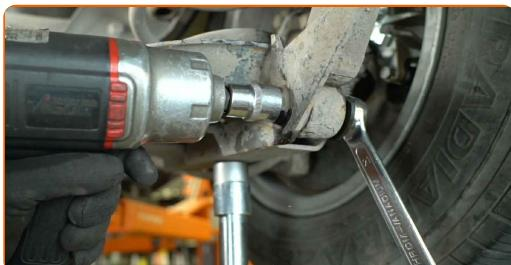
**5** Desenrosque el elemento de sujeción superior del amortiguador. Utilice una llave combinada de 21 mm. Utilice una llave de vaso de 21 mm. Utilice una llave de carraca.
