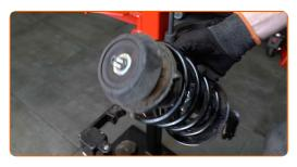
Instale la pata amortiguadora en el arco de la rueda.
