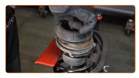
Apriete la tuerca de la varilla de la pata amortiguadora. Use un vaso de impacto del n.º 18. Use Vaso HEX No. H6. Utilice una llave dinamométrica. Apriételo a un par de 50 Nm.
