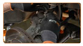
Limpie las sujeciones que conectan el latiguillo de freno con el puntal de suspensión. Use un cepillo de alambre. Use el aerosol WD-40.
