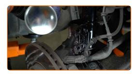
Fije la pata amortiguadora en el muñón de dirección.
