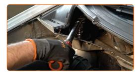
Trate las sujeciones del soporte del amortiguador. Use grasa de cobre.
