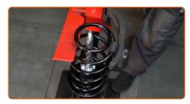
Instale el soporte, el fuelle y el tope en el amortiguador.
