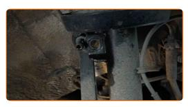
Desconecte el cableado del captador ABS.
