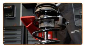
Retire el puntal amortiguador que está montado.
