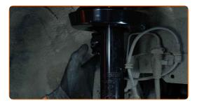
Apriete las fijaciones de la bieleta de la barra estabilizadora. Usa una llave mixta del n.º 19. Use un vaso de impacto del n.º 19. Utilice una llave de trinquete.
