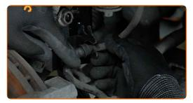
Instale el clip de retención del latiguillo de freno. Utilice alicates.
