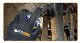
Desatornille la sujeción que conecta la bieleta de barra estabilizadora al amortiguador. Usa una llave mixta del n.º 19. Use un vaso de impacto del n.º 19. Utilice una llave de trinquete.
