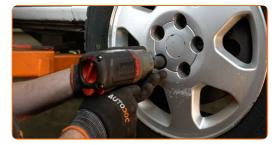
Baje el automóvil y, manteniendo el orden cruzado, apriete los pernos de fijación de las ruedas. Utilice una llave de impacto para llanta # 19. Utilice una llave dinamométrica. Apriételo a un par de 110 Nm.
