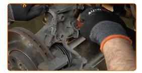
Retire el clip de retención del latiguillo de freno. Utilice alicates.
