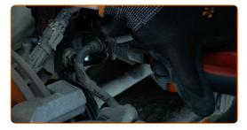
Conecte los cables del captador ABS.
