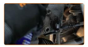
Desatornille la sujeción inferior que conecta el puntal amortiguador a la mangueta de dirección. Usa una llave mixta del n.º 18. Use un vaso de impacto del n.º 18. Utilice una llave giramachos.
