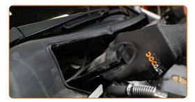
Limpie las sujeciones del soporte superior del puntal amortiguador. Use un cepillo de alambre. Use el aerosol WD-40.
