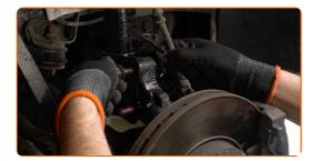
Atornille la sujeción que conecta el puntal de suspensión con la mangueta de dirección. Usa una llave mixta del n.º 18. Use un vaso de impacto del n.º 18. Utilice una llave de trinquete.
