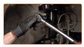
Trate las sujeciones del amortiguador. Use grasa de cobre.
