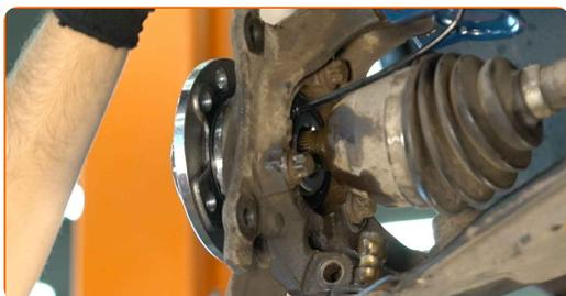
**36** Conecte la palanca inferior al muñón de dirección.
