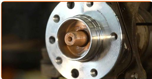
**41** Atornille la fijación del cubo de la rueda. Use un vaso de impacto del n.º 32.
