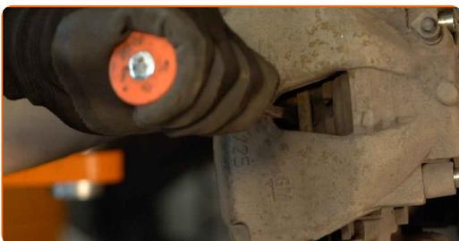
**10** Tire a un lado del muelle de retención de la pinza de freno. Use una palanca.
