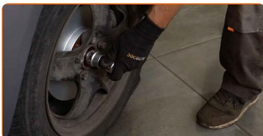
**58** Apriete los pernos de la rueda usando un patrón entrecruzado. Utilice una llave dinamométrica. Apriételo a un par de 110 Nm.
