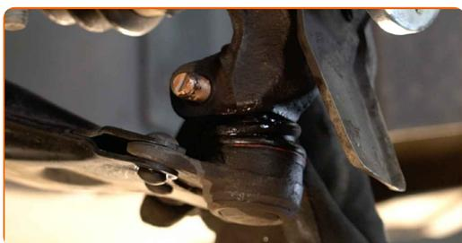
**38** Apriete la fijación del soporte esférico. Usa una llave mixta del n.º 17. Use un vaso de impacto del n.º 19. Utilice una llave dinamométrica. Apriételo a un par de 50 Nm.
