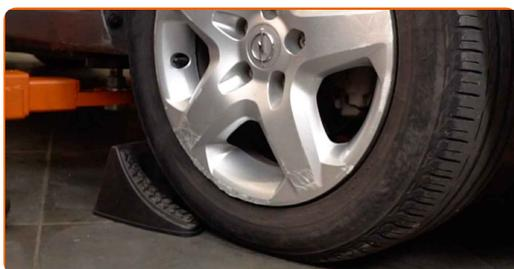
**3** Desenrosque la fijación que conecta el eje de transmisión al cubo de la rueda. Use un vaso de impacto del n.º 32. Utilice una llave giramachos.
