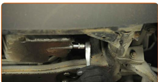
**7** Limpie el área del orificio de drenaje de la bandeja de aceite. Utilice un spray de limpieza multiuso.
