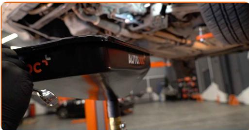
**3** Destornille el tapón de desagüe. Use un vaso de impacto del n.º 13. Utilice una llave de trinquete.
