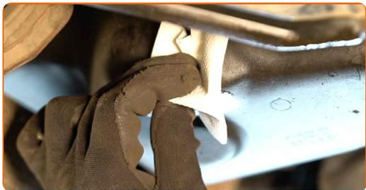
**6** Atornille en el nuevo tapón de drenaje y apriételo. Use un vaso de impacto del n.º 13. Utilice una llave dinamométrica. Apriételo a un par de 30 Nm.
