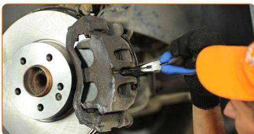
**36** Instale los tapones de los guardapolvos de las guías del cáliper. Utilice un destornillador plano.
