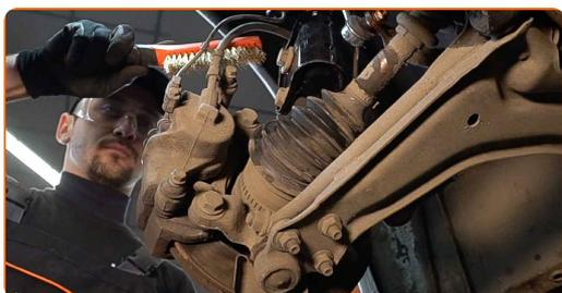
**10** Destornille la fijación del cáliper de freno. Use Vaso HEX No. H6. Utilice una llave de trinquete.
