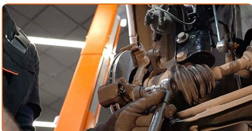
**27** Retire los muelles de retención de las pastillas de freno. Utilice un destornillador plano.
