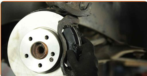
**30** Trate el pistón de la pinza de freno. Utilice un cepillo de limpieza de nylon. Use un limpiador de frenos.
