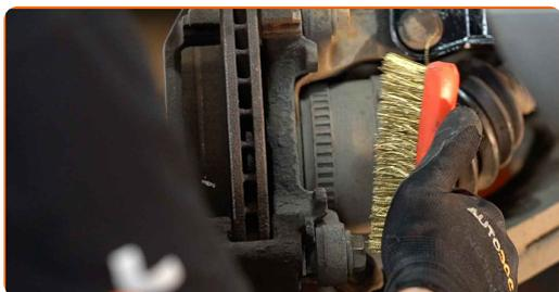
**16** Destornille la fijación de la pinza del cáliper de freno. Use un vaso de impacto del n.º 21. Utilice una llave de trinquete.
