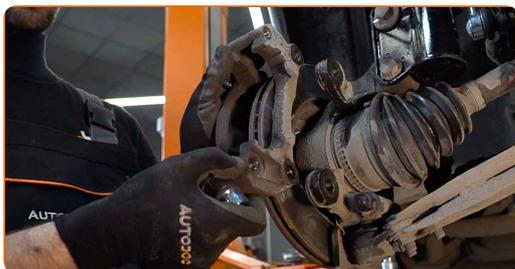
**18** Limpie la sujeción del disco de freno. Use un cepillo de alambre. Use el aerosol WD-40.
