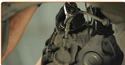
**35** Conecte la clavija del sensor de desgaste de las pastillas de freno.
