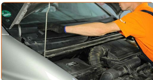
**57** Instale la fijación del filtro de habitáculo. Utilice Torx T25. Utilice una llave dinamométrica. Apriételo a un par de 11 Nm.
