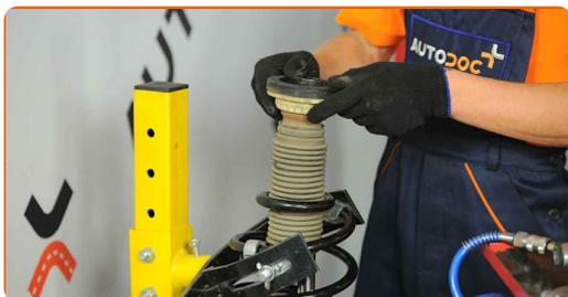
**45** Apriete la tuerca de la varilla de la pata amortiguadora. Use un vaso de impacto del n.º 20. Utilice una llave dinamométrica. Apriételo a un par de 56 Nm.
