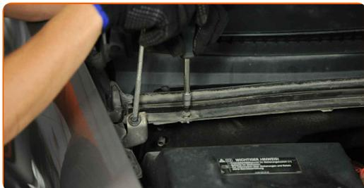
**20** Retire los clips de la rejilla de ventilación plástico del capó. Utilice un destornillador plano. Utilice alicates para abrazaderas de oreja.
