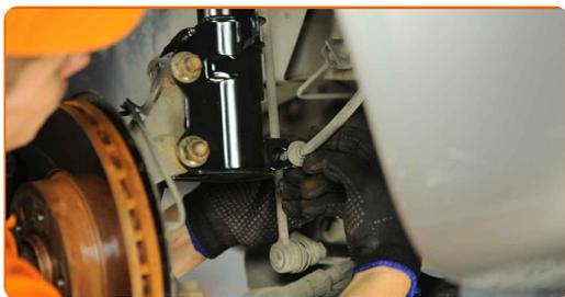
**72** Fije el enlace estabilizador de el soporte de amortiguador. Use una palanca.
