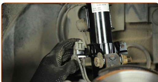
**75** Conecte el cableado del sensor ABS.
