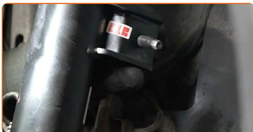
**73** Apriete la sujeción que conecta la bieleta de barra estabilizadora al amortiguador. Use un vaso de impacto del n.º 18. Utilice una llave dinamométrica. Apriételo a un par de 85 Nm.
