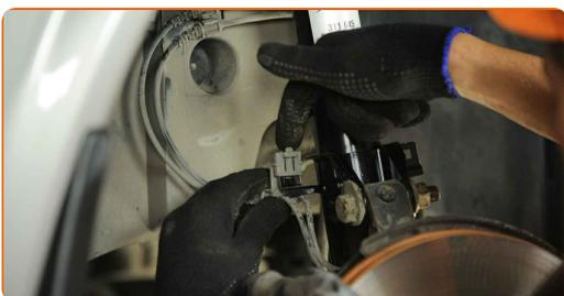
**11** Desconecte el cableado del sensor ABS.
