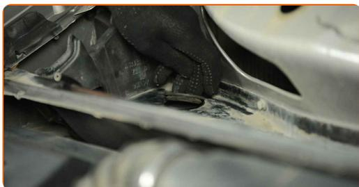
**52** Enchufe el conector del motor del limpiaparabrisas.
