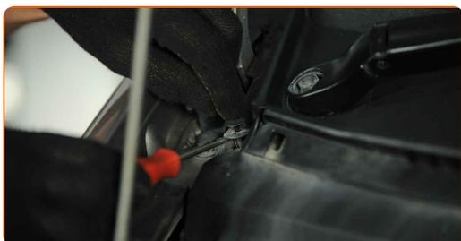
**21** Desenrosque las fijaciones de los brazos del limpiaparabrisas. Use un vaso de impacto del n.º 13. Utilice una llave de trinquete.
