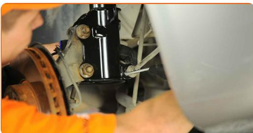
**10** Suelte el arnés de cables del sensor ABS del soporte del amortiguador. Desconecte la sujeción del cable del sensor de desgaste de las pastillas de freno del puntal de suspensión.
