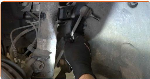
**9** Separe el latiguillo de freno del puntal amortiguador. Utilice un destornillador plano.
