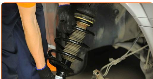
**49** Atornillen la fijación superior de la cazoleta de la pata amortiguadora.
