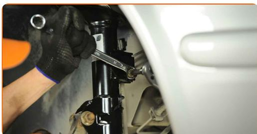
**74** Conecte la fijación del cable del sensor ABS a la pata amortiguadora. Conecte la sujeción del cable del sensor de desgaste de las pastillas de freno al puntal de suspensión.
