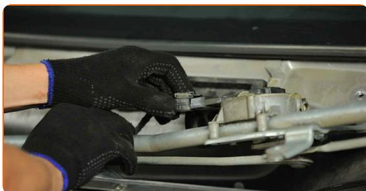
**53** Instale el panel que está ensamblado con el varillaje del limpiaparabrisas.
