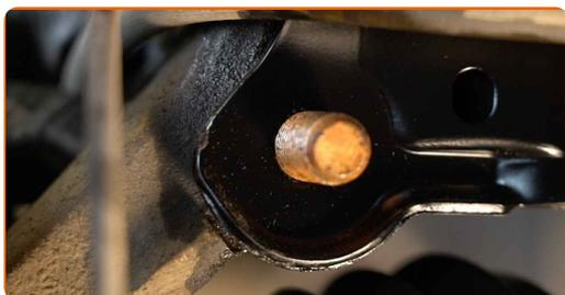
**70** Apriete las sujeciones inferiores que conectan el amortiguador con la mangueta de dirección. Usa una llave mixta del n.º 21. Use un vaso de impacto del n.º 21. Utilice una llave dinamométrica. Apriételo a un par de 120 Nm.+75°
