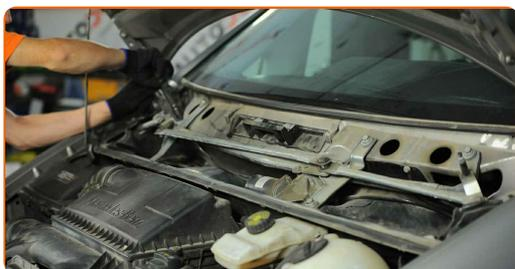
**55** Acople la manguera de la boquilla del limpiaparabrisas.
