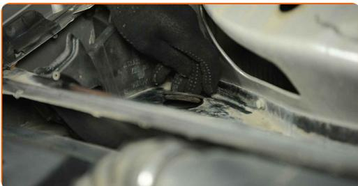
**53** Enchufe el conector del motor del limpiaparabrisas.
