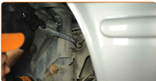
**8** Retire el enlace estabilizador de estabilidad transversal.
