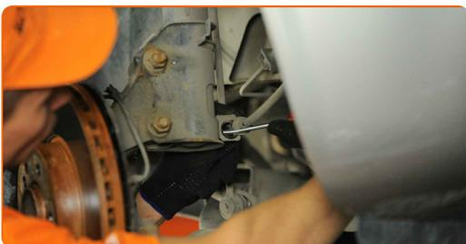
**10** Desconecte el cableado del sensor ABS. Desconecte la sujeción del cable del sensor de desgaste de las pastillas de freno del puntal de suspensión. Utilice un destornillador plano.
