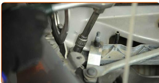
**28** Retire el panel que está ensamblado con el varillaje del limpiaparabrisas.
