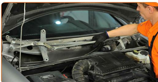
**29** Desenchufe el conector del motor del limpiaparabrisas. Utilice un destornillador plano.
