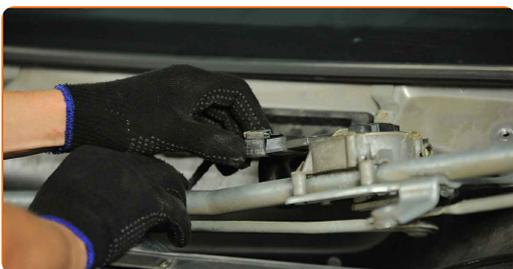
**54** Instale el panel que está ensamblado con el varillaje del limpiaparabrisas.
