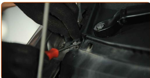
**20** Desenrosque las fijaciones de los brazos del limpiaparabrisas. Use un vaso de impacto del n.º 13. Utilice una llave de trinquete.
