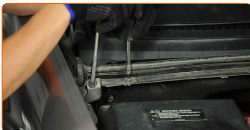
**19** Retire los clips de la rejilla de ventilación plástico del capó. Utilice un destornillador plano. Utilice alicates para abrazaderas de oreja.
