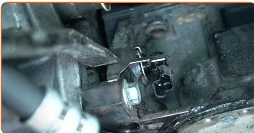
**5** Retire el sensor de posición del cigüeñal.
