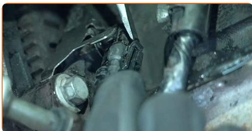
**4** Presione sobre el muelle de retención del sensor de posición del cigüeñal. Utilice una palanca de montaje.
