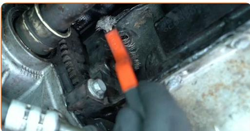
**8** Trate el conector del sensor de posición del cigüeñal. Utilice un spray para contactos eléctricos.
