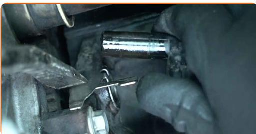
**6** Retire el muelle de retención del sensor de posición del cigüeñal.
