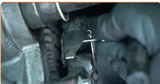
**7** Limpie el asiento de montaje del sensor de posición del cigüeñal. Utilice un cepillo de alambre. Utilice un spray limpiador multiusos.
