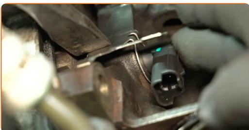
**12** Una el conector del sensor de posición del cigüeñal.
