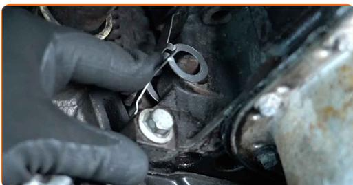
**10** Presione sobre el muelle de retención del sensor de posición del cigüeñal. Utilice una palanca de montaje.
