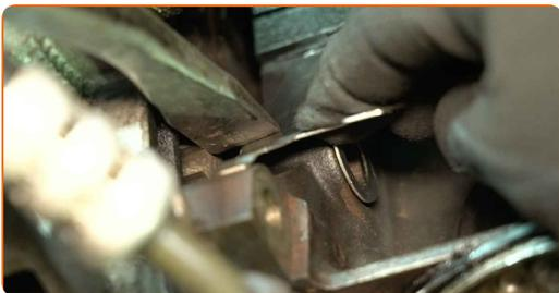
**11** Instale el nuevo sensor de posición del cigüeñal.
