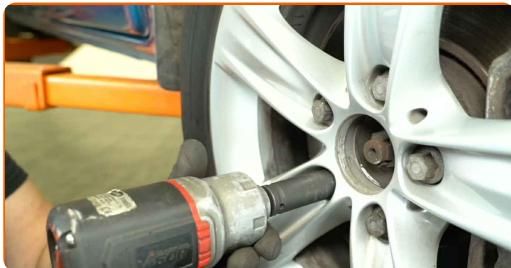
**19** Baje el coche y apriete los elementos de sujeción de la rueda siguiendo un orden entrecruzado. Utilice un vaso de impacto para ruedas de 19 mm. Utilice una llave dinamométrica. Par de apriete: 142 N·m.
