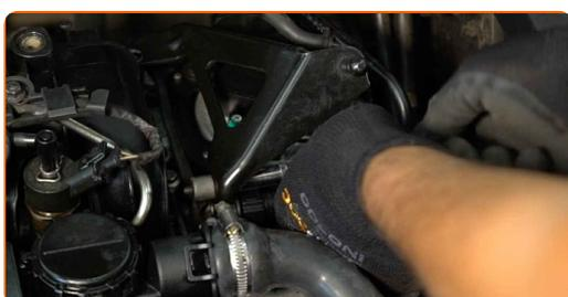
5 Desconecte el conector del sensor de presión de combustible. Utilice un destornillador plano.
