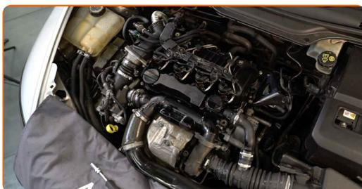
**4** Destornille los bulones de fijación del soporte del filtro de combustible. Use un vaso de impacto del n.º 8. Use un vaso de impacto del n.º 10. Utilice una llave de trinquete.
