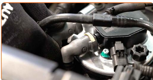
14 Atornille los bulones de fijación del soporte del filtro de combustible. Use un vaso de impacto del n.º 8. Use un vaso de impacto del n.º 10. Utilice una llave de trinquete.
