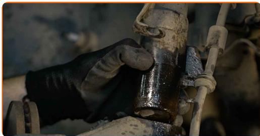
**28** Destornille la fijación superior de la cazoleta de la pata amortiguadora.
