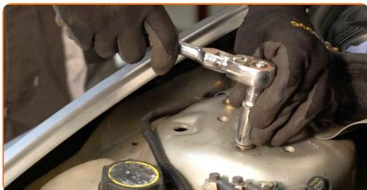
**69** Trate las sujeciones del amortiguador. Trate la varilla del amortiguador. Use grasa de cobre.
