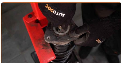
**41** Apriete la tuerca de la varilla de la pata amortiguadora. Use Vaso HEX No. H6. Use un vaso de impacto del n.º 18. Utilice una llave dinamométrica. Apriételo a un par de 50 Nm.
