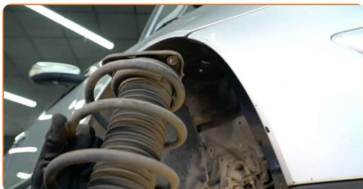
**30** Instale la pata amortiguadora en el mecanismo para apretar los resortes.
