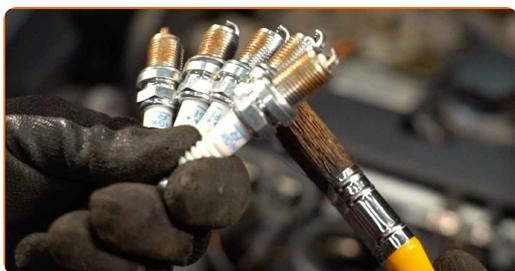
**16** Instale las nuevas bujías en sus asientos de montaje.
