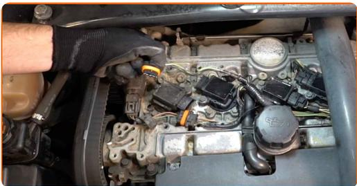
**6** Desconecte la fijación del tubo de admisión de aire. Use un vaso de impacto del n.º 10. Utilice una llave de trinquete.
