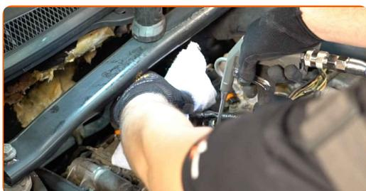
**13** Desenrosque las bujías. Use el vaso de bujía # 16. Utilice una llave de trinquete.
