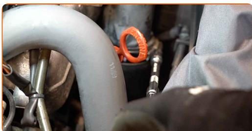
**26** Atornille la sujeción del tubo de admisión de aire. Use un vaso de impacto del n.º 10. Utilice una llave de trinquete.
