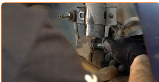
**13** Desconecte el muñón de dirección de la pata amortiguadora.
