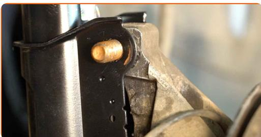
**42** Apriete las sujeciones inferiores que conectan el amortiguador con la mangueta de dirección. Usa una llave mixta del n.º 18. Use un vaso de impacto del n.º 21. Utilice una llave dinamométrica. Apriételo a un par de 105 Nm.+75°
