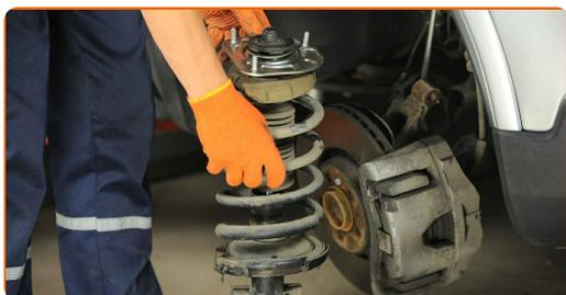
**34** Fije las sujeciones superiores del puntal amortiguador.
