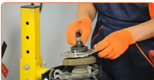
**32** Retire el puntal amortiguador que está montado.
