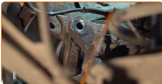
**24** Apriete la fijación de la pinza del cáliper de freno. Use un vaso de impacto del n.º 13. Utilice una llave dinamométrica. Apriételo a un par de 60 Nm.
