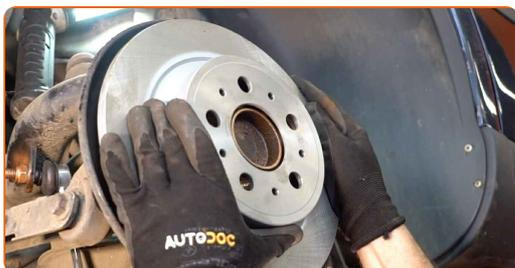
**21** Apriete la fijación del disco de freno. Use un vaso de impacto del n.º 10. Utilice una llave dinamométrica. Apriételo a un par de 9 Nm.
